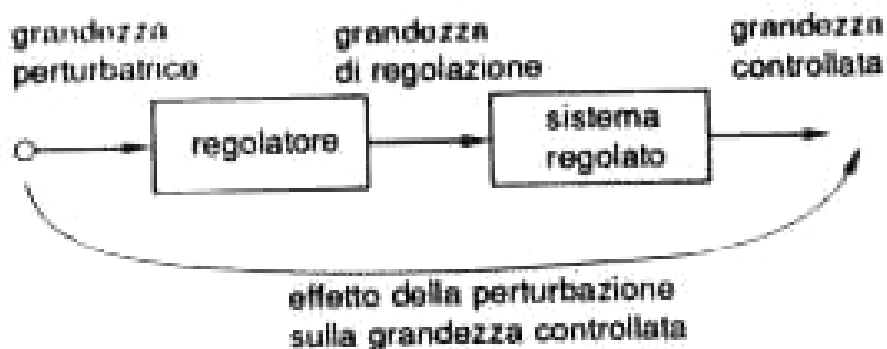
Fig.2.1.1-Principio generale della regolazione in circuito aperto.
