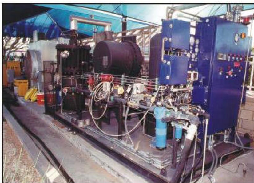
Reformer di medie dimensioni alimentato da gas naturale
