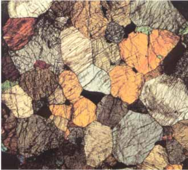
Olocristallina granulare (20 ingrandimenti)
