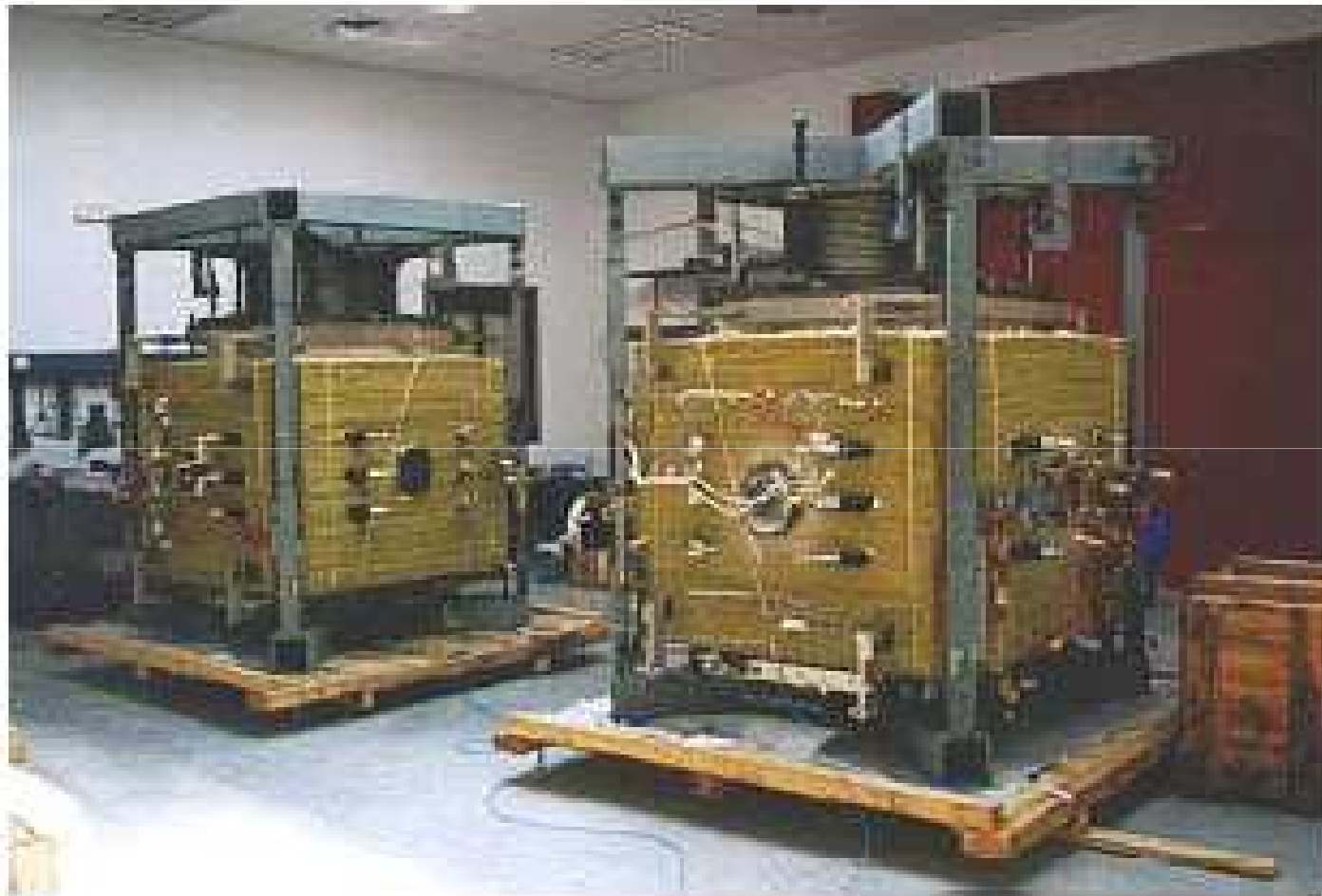
Moduli per impianto MCFC da 100 kW (laboratori Ansaldo Ricerche)
