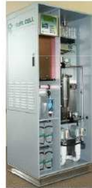
Impianto FCT da 5 kW
