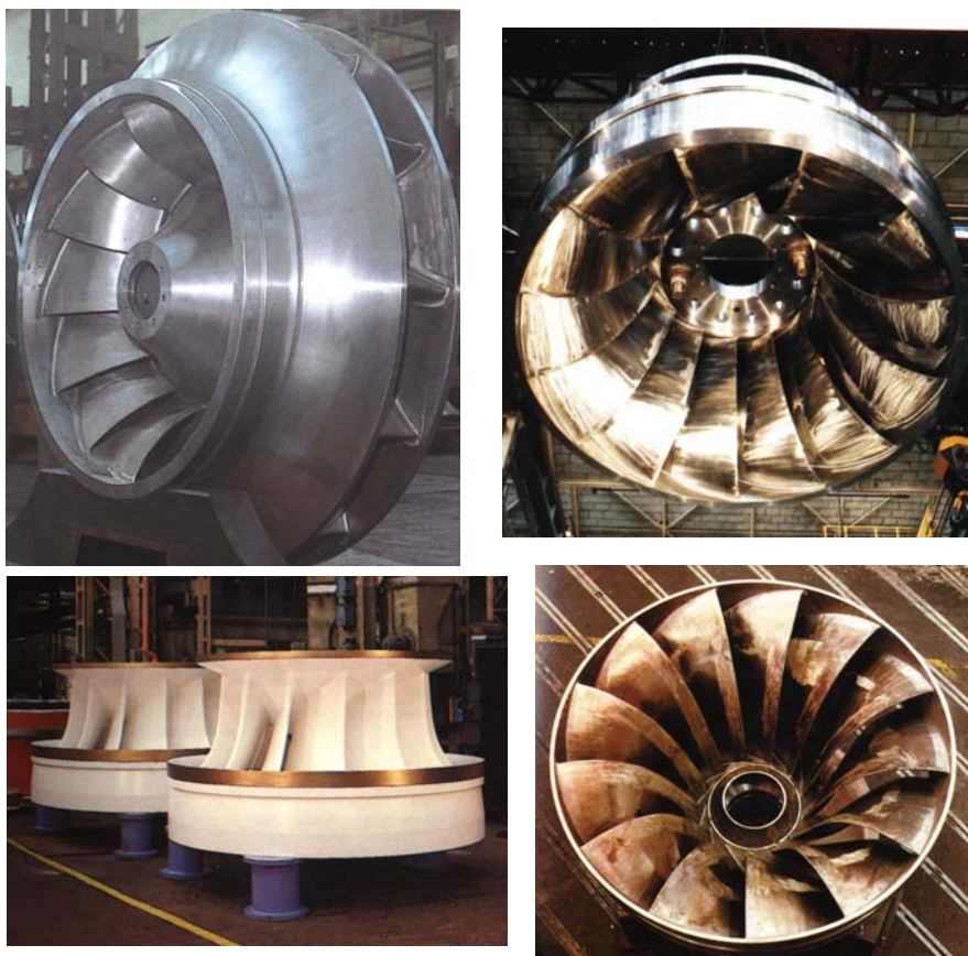
Foto di alcune giranti per turbine Francis dalle quali appaiono chiaramente le notevoli differenze che possono verificarsi in funzione delle caratteristiche ( H_u , Q_v , n ) sotto cui opera l'impianto
