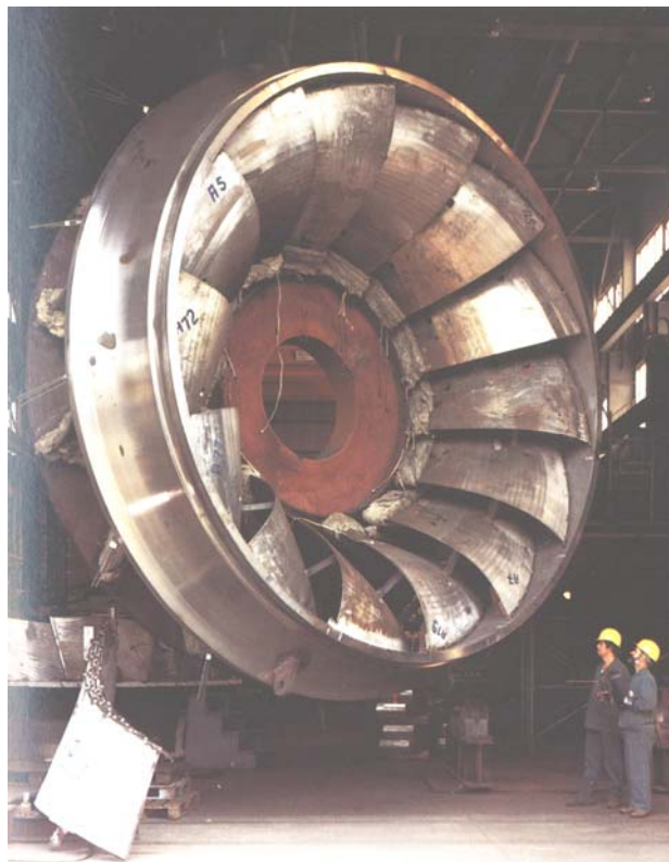
Foto di una girante di turbina Francis.
