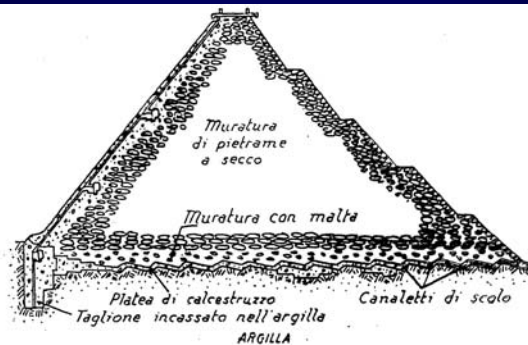
Fig.87. Sezione trasversale di una diga a scogliera (diga di Gela, da Contessini).
