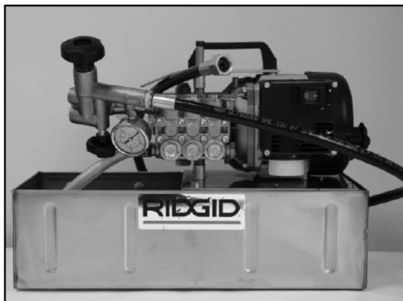
Fig. 2 Pompa volumetrica e vasca di raccolta acqua
