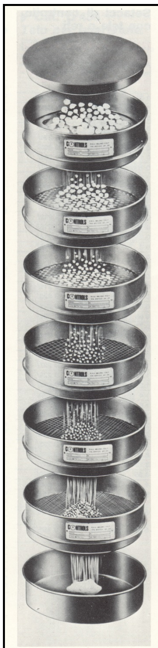
Analisi granulometrica per setacciatura mediante crivelli con maglia metallica di dimensioni via via decrescenti.
