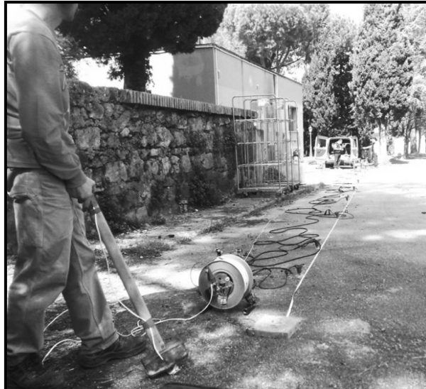
Fase di acquisizione dei segnali sismici. In primo piano, la massa battente usata per generare i segnali
