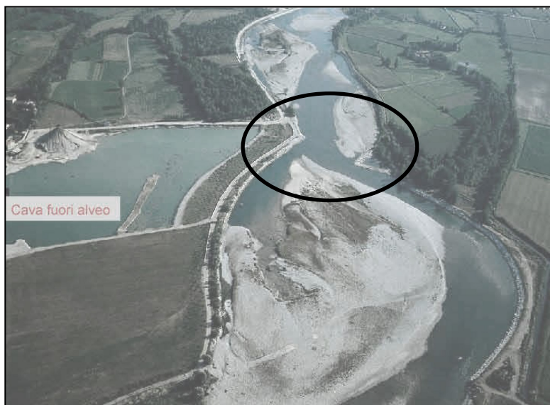
Alveo del fiume Ticino con cava di ghiaia nella subalvea e difese spondali radenti. La presenza di depositi alluvionali nel canale di magra e di opere rigide che ostacolano il deflusso delle acque in fase di piena possono determinare situazioni di elevata pericolosità idraulica.
