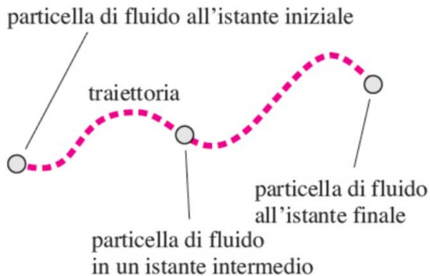
Figura 4.19 Una traiettoria è il luogo dei punti raggiunti da una particella nei successivi istanti.
