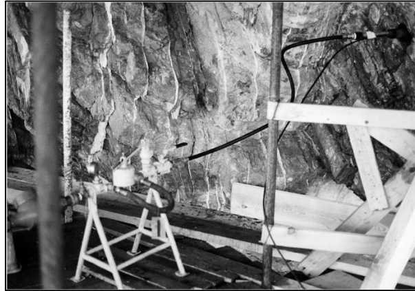
Prova d'assorbimento eseguita in foro di sondaggio orizzontale. In primo piano, si osserva la pompa con il contaltri dal quale si diparte la tubazione inserita nel foro.
