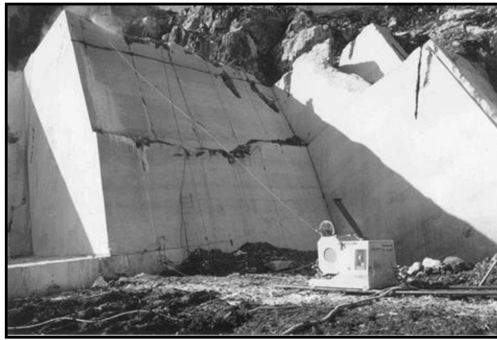
Tagliatrice a filo diamantato all'opera per il taglio di una fetta di marmo
