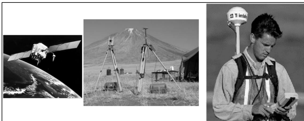
Strumentazione GPS: a) satellite in orbita geostazionaria; b) strumentazione fissa per la ricezione del segnale a terra; c) strumentazione mobile ( rover ) per l'acquisizione del segnale.
