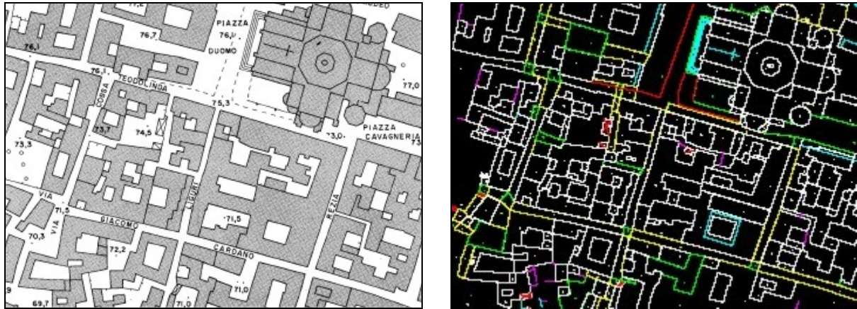
Confronto tra le immagini rasterizzate (sinistra) e vettorializzate (destra) di una stessa porzione di cartografia 1:2000.
