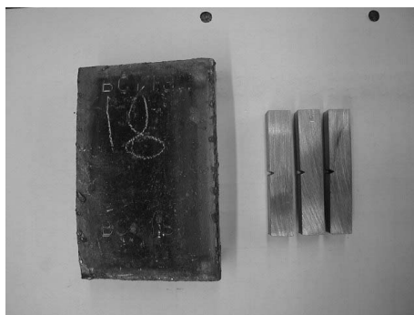
Pezzo e Provini ricavati (British Steel)
