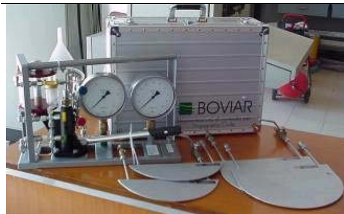
Fig.17: Martinetti piatti semiovali con pompa idraulica
