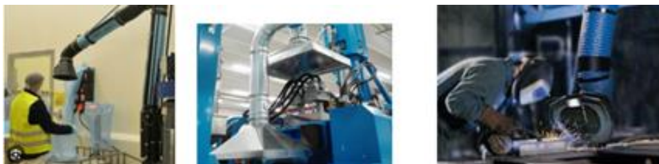
Figura. Tipologia di controllo con aspirazione locale.
