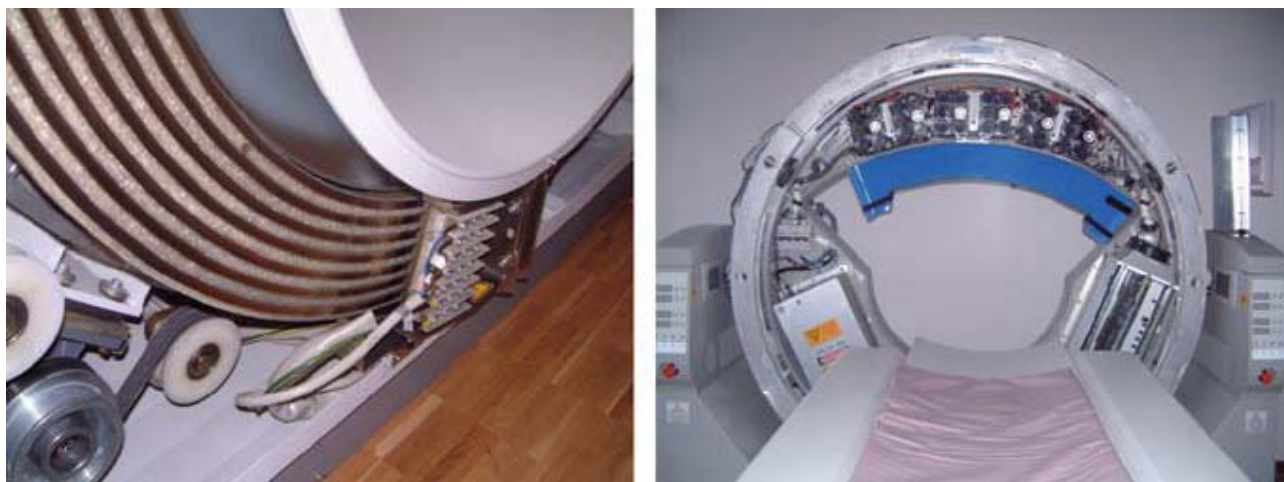
Figura 25: Diversi metodi di trasferimento di energia per l'unità in rotazione. Nel Siemens Somatom AR.T (a sinistra), è usata la tecnologia ad anelli. Nel CT scanner compatto Tomoscan della Philips M (a destra) viene usata una matrice di accumulatore
