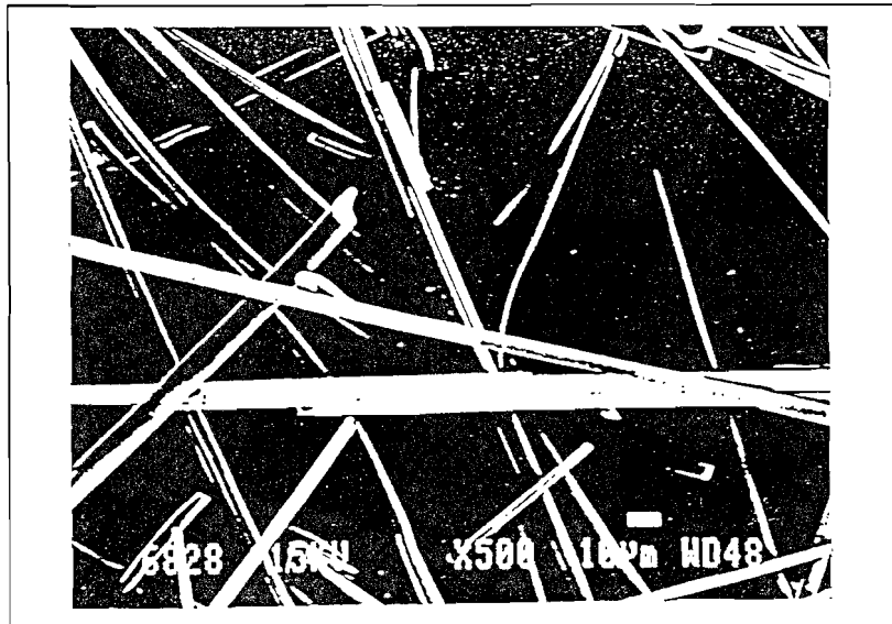
fig.2- Micrografia delle fibre minerali ingrandite 500 volte
