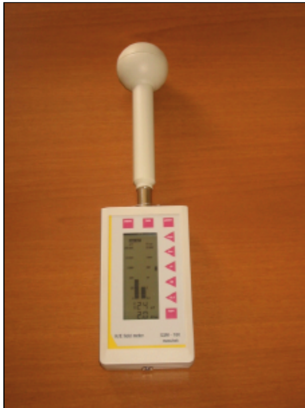
Figura 3.39: sensore e rilevatore per misure di campo elettrico.
