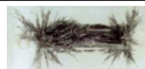
Limatura di ferro attorno ad un magnete permanente (calamita)
