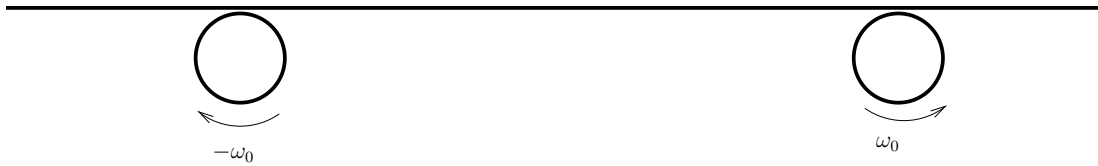
Figura 6.4.: La sbarra appoggiata sui rulli rotanti considerata nel problema. Viene indicata la direzione di rotazione.
