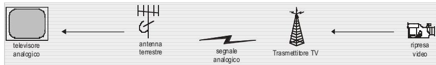
Figura 1. Schema di trasporto della televisione analogica terrestre
