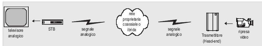
Figura 6. Schema di trasporto della televisione via cavo analogica
