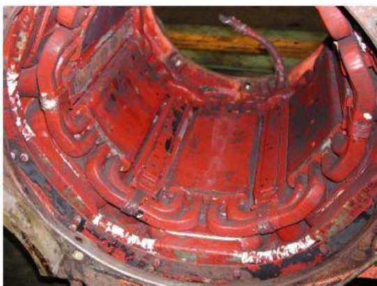
Fig.2.18 Indotto o Armatura (rotore). Fig.2.19 Eccitazione o Induttore (statore).
