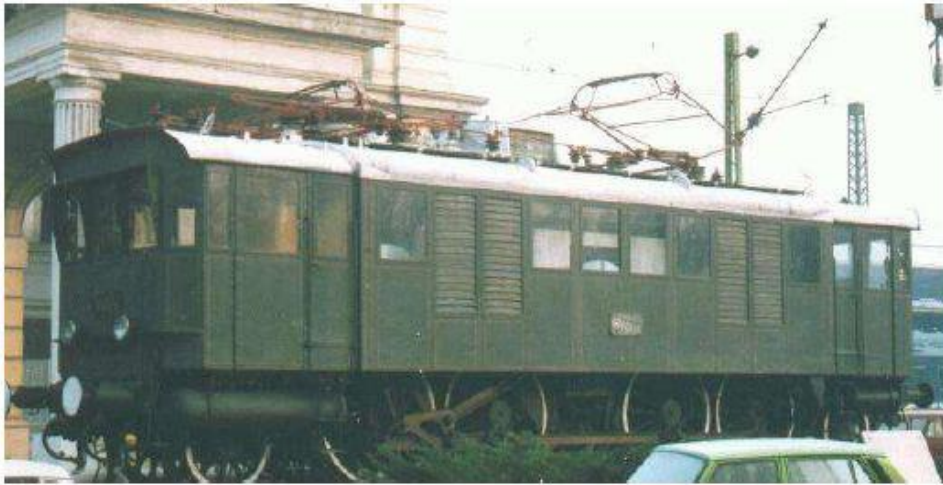
Fig. 1.10 Locomotiva V60 con V = 20 \text{ kV} e f = 50 \text{ Hz} sulla linea Budapest-Hegyeshalom(1932).
