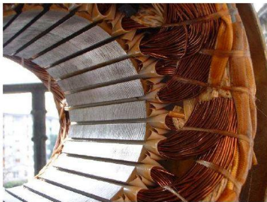
Figura 2.35 Dettaglio dello statore di un motore ad induzione. Figura 2.36 Rotore del motore ad induzione a gabbia di scoiattolo.
