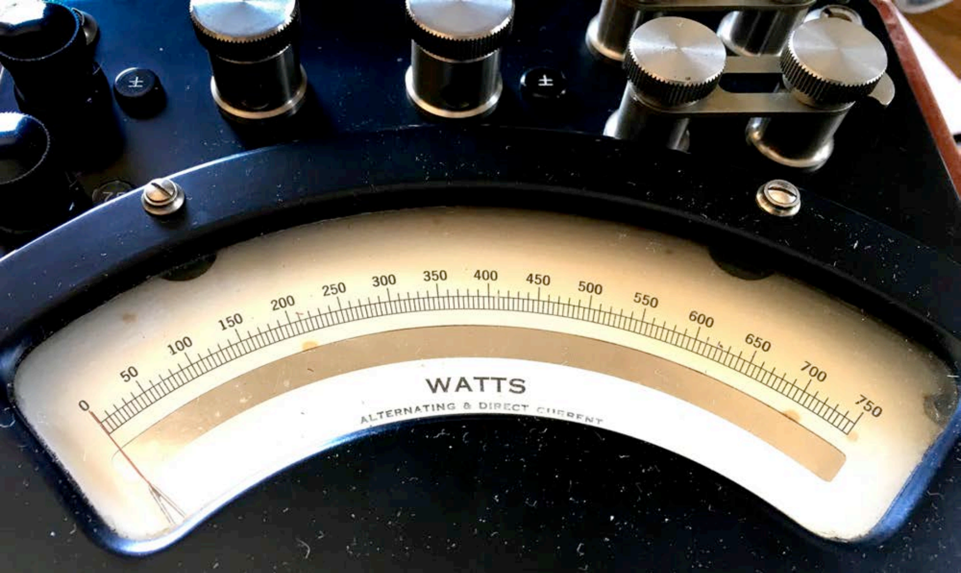
Scala (lineare) del wattmetro elettrodinamico Weston
