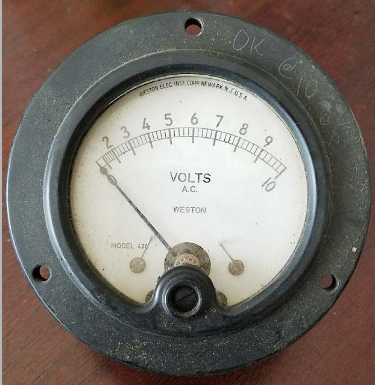
Modello industriale di voltmetro elettrodinamico Weston con la caratteristica scala quadratica
