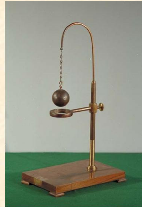
Dilatazione termica di una sfera e di un anello
