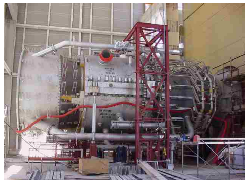
Turbogas Siemens V94 3/A (Gruppo2 Priolo G.)
