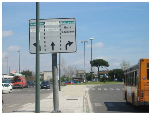
Figura 9 Segnaletica di preselezione installato, sul lato errato, in luogo del segnale preavviso rotatoria (rotatoria 8, V.le Metamorfosi).
