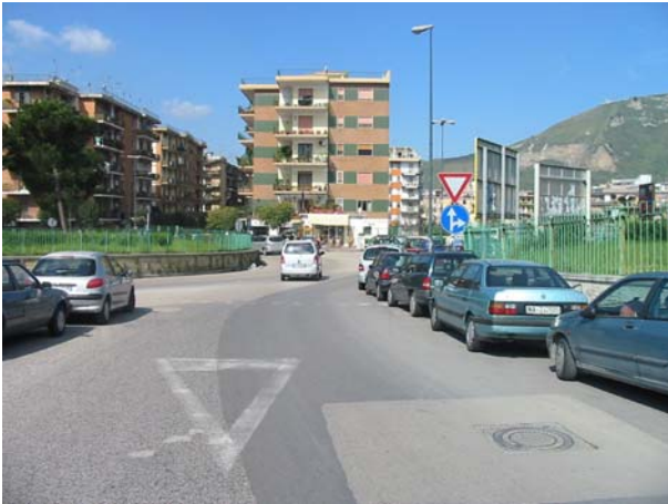
Figura 10 Segnale direzione obbligatoria installato in luogo del segnale rotatoria (rotatoria 4, raccordo con la Tangenziale).
