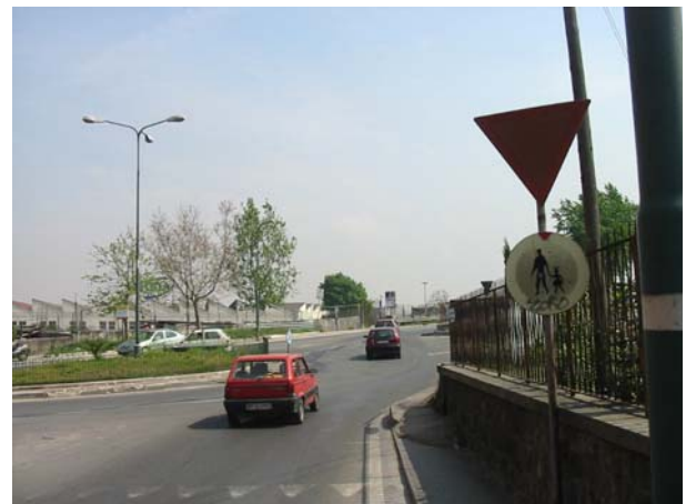
Figura 14 Segnale dare precedenza inefficace (rotatoria 9, cavalcavia di Ponticelli).
