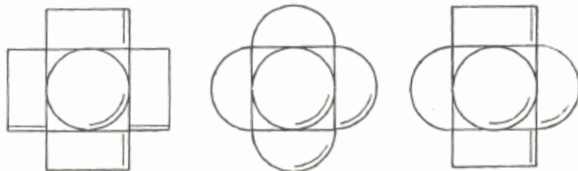
(a) (b) (c) Sistemi bizantini di sostegno delle alte cupole
